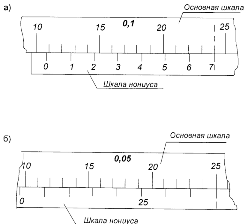
Рис. 8. Отсчет штангенинструментами различной точности а) класс точности 0,1; б) класс точности 0,05
